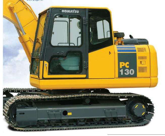
HORSEPOWER Net: 66 kW 89 HP / 2200 min<sup>-1</sup>
